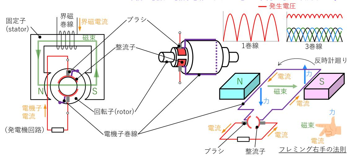
電機子巻線が半回転しても整流子によって同じ方向に電流が流れる
