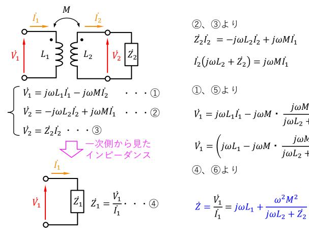
$\dot{V}_1 = j\omega L_1 \dot{I}_1 - j\omega M \cdot \frac{j\omega M I_1}{i\omega L_2 + \dot{Z}_2}$
