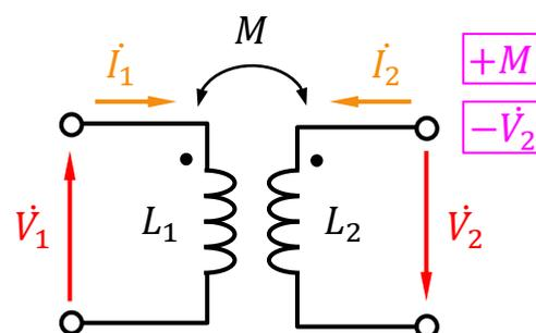
$$\begin{aligned} \dot{V}_1 &= j\omega L_1 \dot{I}_1 + j\omega M \dot{I}_2 \\ \dot{V}_2 &= -j\omega L_2 \dot{I}_2 - j\omega M \dot{I}_1 \\ (-\dot{V}_2 &= j\omega L_2 \dot{I}_2 + j\omega M \dot{I}_1) \end{aligned}$$
