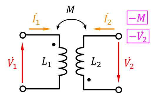
$$\begin{aligned} \dot{V}_1 &= j\omega L_1 \dot{I}_1 - j\omega M \dot{I}_2 \\ \dot{V}_2 &= -j\omega L_2 \dot{I}_2 + j\omega M \dot{I}_1 \\ (-\dot{V}_2 &= j\omega L_2 \dot{I}_2 - j\omega M \dot{I}_1) \end{aligned}$$
