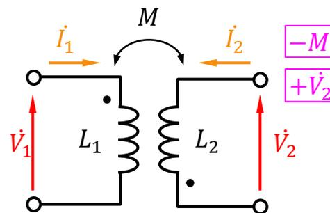
$$\begin{aligned} \dot{V}_1 &= j\omega L_1 \dot{I}_1 - j\omega M \dot{I}_2 \\ \dot{V}_2 &= j\omega L_2 \dot{I}_2 - j\omega M \dot{I}_1 \end{aligned}$$
