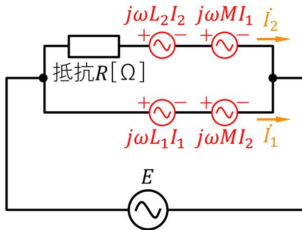
$$\begin{cases} j\omega L_1 I_1 + j\omega M I_2 = E \\ j\omega M I_1 + (R + j\omega L_2) I_2 = E \end{cases}$$
