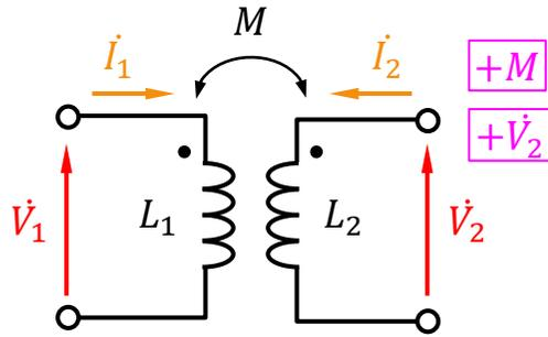
$$\begin{aligned} \dot{V}_1 &= j\omega L_1 \dot{I}_1 + j\omega M \dot{I}_2 \\ \dot{V}_2 &= j\omega L_2 \dot{I}_2 + j\omega M \dot{I}_1 \end{aligned}$$
