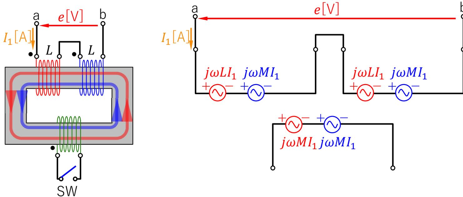
$$e = j\omega L_{ab} I_1 = j\omega LI_1 + j\omega MI_1 + j\omega LI_1 + j\omega MI_1 = j\omega(2L + 2M)I_1$$
