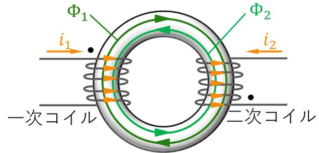
一つのコイルが、ドットが付いていない側から電流が流れてくると、コイルに発生する磁束の向きは逆となる。(差動接続)
