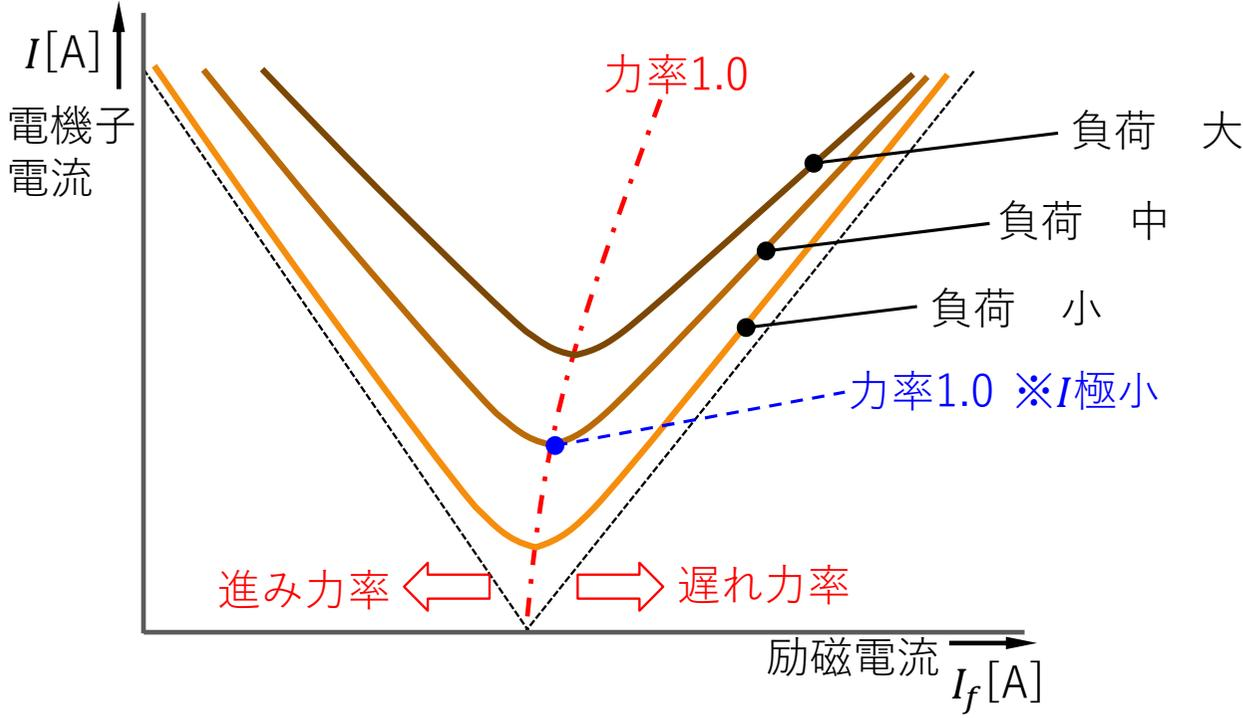
励磁電流を調節することで力率を調整することができる。
