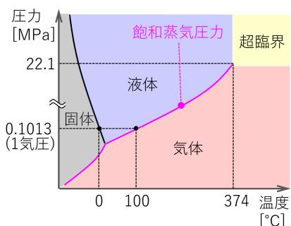
羽根車表面付近は流速が高まるので圧力が下がる。 飽和蒸気圧力以下になるとキャビテーションが生じる。
