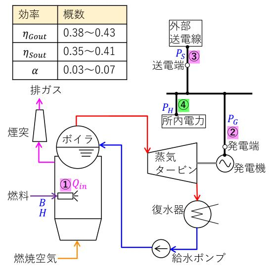
燃料消費量[kg/h]: B 燃料の発熱量[kJ/kg]: H
